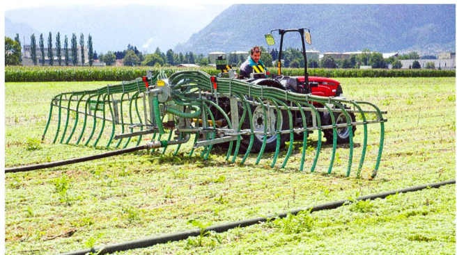
Fig. 2: Sur les systèmes non ventilés, la tête de distribution peut être installée plus bas (photo: Joachim Sauter, ART).
