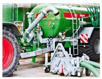
Fig. 11: Les séparateurs mobiles pour remplissage de citerne peuvent également retenir les corps étrangers flottants (photo: GVS, Schaffhausen).
