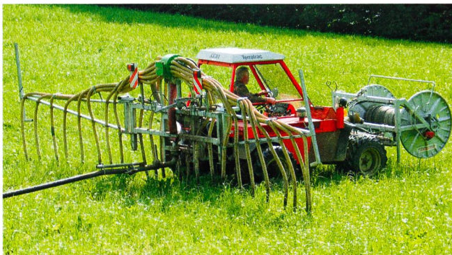
Fig. 1: La tête de distribution ventilée doit toujours se situer au point le plus élevé pour que le lisier puisse s'écouler dans les tuyaux (photo: Joachim Sauter, ART).
