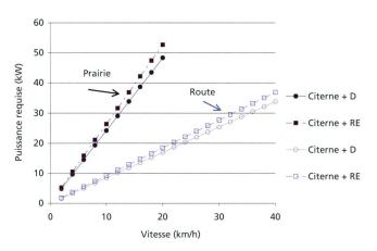
Fig. 3: Puissance de traction requise pour tracter une citerne avec distributeur (D), 11,1t, et une citerne avec rampe d'épandage à tuyaux souples (RE), 12,1 t, sur prairie et sur route (déclivité = 0 %, résistance au roulement sur prairie = 0,08, résistance au roulement sur route = 0,028).
