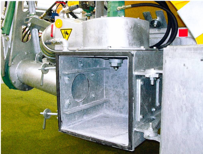
Fig. 10: Les dispositifs de coupe raccordés à la citerne, avec séparateur supplémentaire de corps étrangers réduisent efficacement les bourrages (photo: Joachim Sauter, ART).
