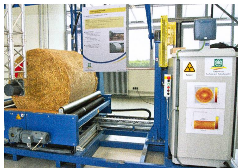
Le stand mobile pour tester la densité au centre d'essais de la DLG à Gross-Umstadt (land de Hesse) donne, par un procédé radiométrique, une description précise de la densité avec une illustration tridimensionnelle.
