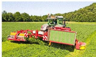
Les protections latérales peuvent être repliées hydrauliquement depuis la cabine avec la commande Power Control, compatible Isobus. Les commandes Select Control ou Power Control sont proposées au choix. Le Select Control permet une sélection de la fonction. Le Power Control commande directement les fonctions hydrauliques, même de la faucheuse frontale (nécessite le pompage continu ou un circuit hydraulique à détection de charge LS).
