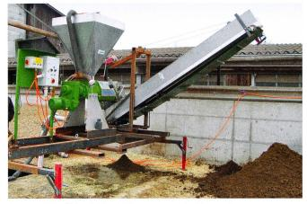
**Bauer Modèle S655 HD** avec tamis Heavy Duty pour une utilisation où une teneur élevée en MS dans la matière solide est requise.
