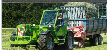
Merlo Multifarmer: Elévateur télescopique et tracteur en un. Avec relevage 3 points et prise de force mécanique
