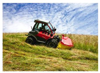
Reform G 6X: Construction compacte avec des roues placées bien à l'extérieur assurant une stabilité et une maniabilité de premier ordre.
