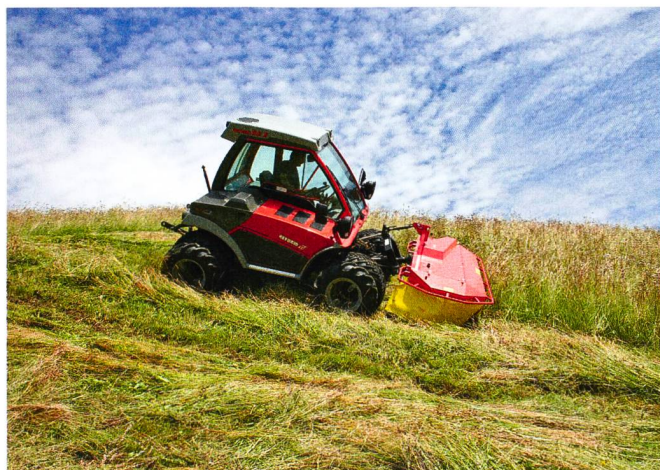
Reform G 6X: Construction compacte avec des roues placées bien à l'extérieur assurant une stabilité et une maniabilité de premier ordre.
