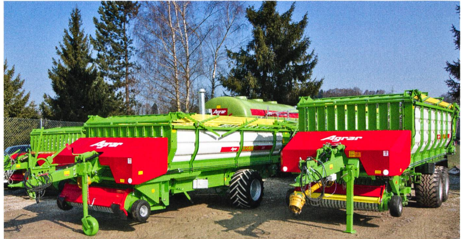
Remorque Mammut surbaissée, et Bison, la remorque à tout faire avec convoyeur oscillant; des exemples de l'équipement modulaire.
