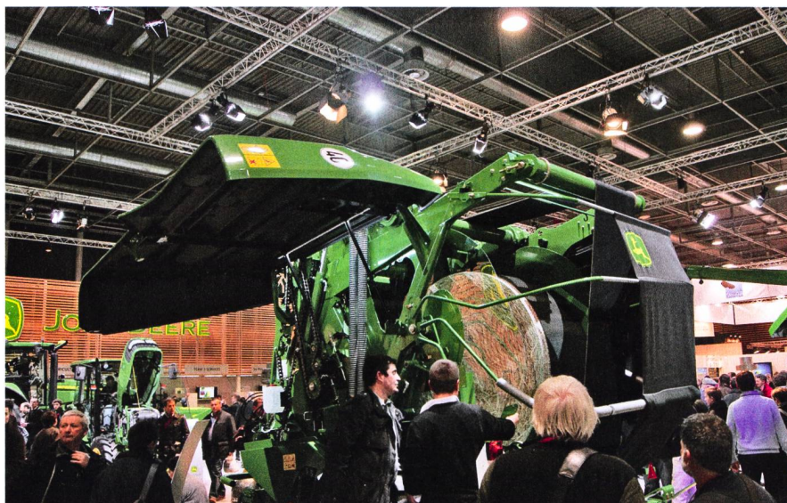
Nouvelle presse à balles rondes 960 (diamètre 60-160 cm) et 990 (60-185 cm) de John Deere avec nouveau dispositif d'éjection capable de réaliser ce travail en quelques secondes. Malgré la chambre variable, une forte densité est atteinte.
