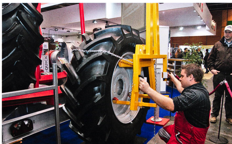
Sur le stand de Schaad, Subingen, un dispositif d'assistance sur le Twin-Carrier facilite le montage des roues.
