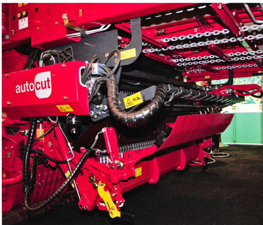
Pöttinger équipe son autochargeuse Jumbo d'un système d'aiguisage automatique Autocut. Il est ainsi possible d'aiguiser les couteaux régulièrement pendant les trajets à vide.
