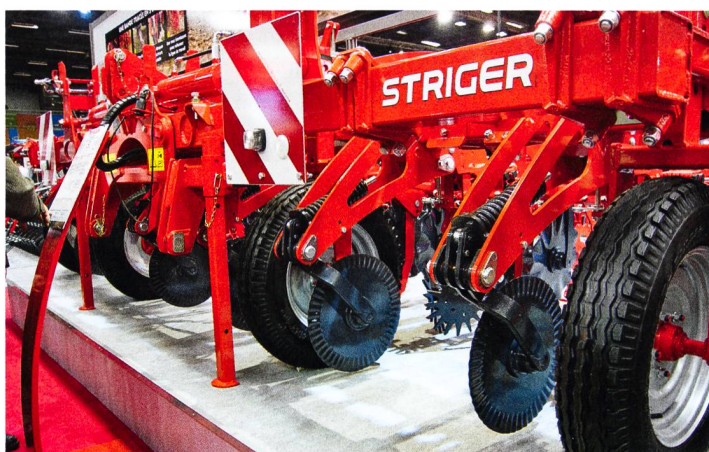
Socs de semis à disque chez Sully: aussi bien après labour que dans les résidus de récolte, un mécanisme à ressort peut être réglé en traction ou en pression, afin de soulager le soc en terrain meuble ou le presser au sol lors du semis sous litière.
