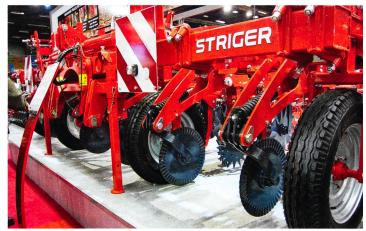
Socs de semis à disque chez Sulky: aussi bien après labour que dans les résidus de récolte, un mécanisme à ressort peut être réglé en traction ou en pression, afin de soulager le soc en terrain meuble ou le presser au sol lors du semis sous litière.
