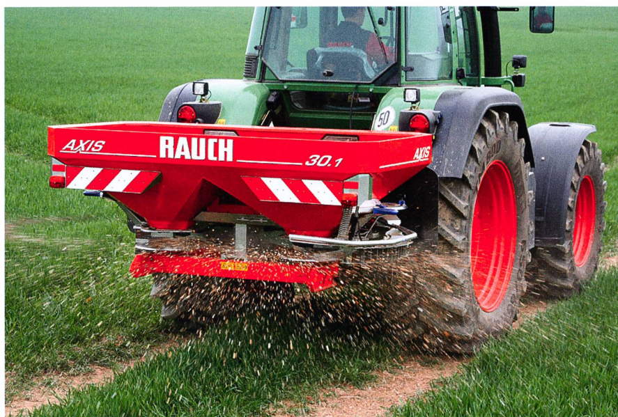
La technique de répartition des épandeurs centrifuges atteint des limites physiques avec 50 mètres.
