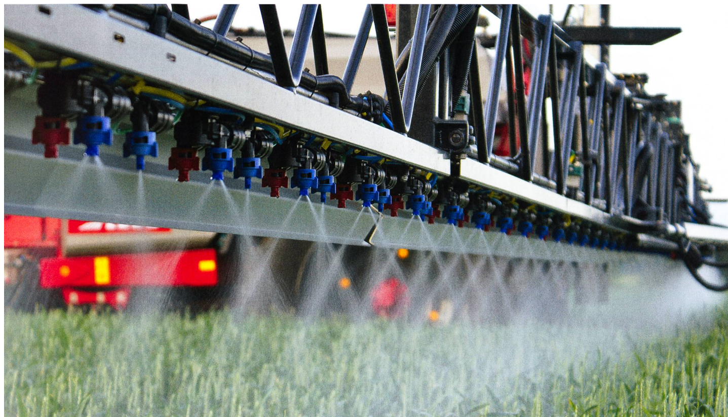
Les buses à double fente assurent une application sur les deux côtés de la plante, même à des vitesses supérieures à 8 km/h.
