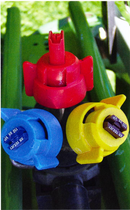
Grâce à des porte-buses multiples, différentes buses sont disponibles pour plusieurs usages.
