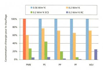
PMB = Porcherie de mise bas, PS = Porcherie de sevrage PP = Porcherie de pré-engraissement, PF = Porcherie de finition HEV = Halle d'engraissement de volaille
