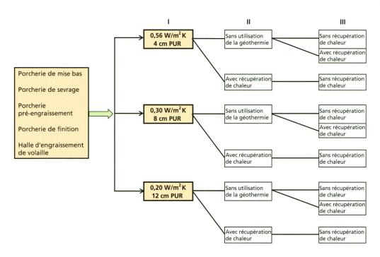
Fig. 2: Simulations réalisées pour différents types de porcheries/halles et différentes mesures d'économie d'énergie.
