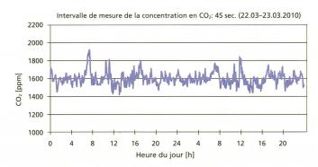
Fig. 7: Une adaptation plus fréquente du débit de ventilation (intervalle de 45 secondes) permet un meilleur réajustement de la concentration en CO<sub>2</sub> à la valeur de consigne (1600 ppm).
