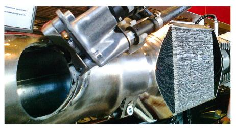
Coupe: aperçu du flux des gaz d'échappement avec le filtre à particules et la technologie SCR à capteur, ainsi que les buses d'injection de AdBlue permettant la neutralisation de l'oxyde d'azote.
