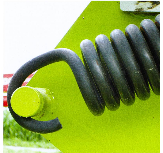
Les systèmes de décharge par ressort remplissent parfaitement leur rôle, mais offrent moins de confort et ne sont souvent pas réglés en cours de travail.
