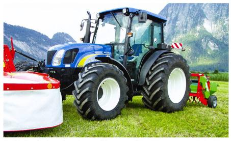
Combinaison faucheuse frontale et conditionneuse arrière.
