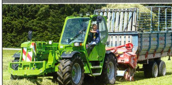
Merlo Multifarm: Elévateur télescopique et tracteur en un. Avec relevage 3 points et prise de force mécanique
