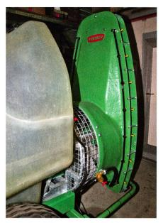
Les turbo-diffuseurs carrossées des coques typiques en polyester et équipés des déflecteurs réglables pour une application optimale.
