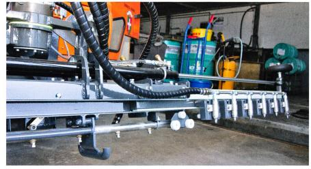
Autre créneau : les rampes de nettoyage pour les balayeuses automobiles avec rallonges latérales, de même qu'un mécanisme stop/go des buses activées.
