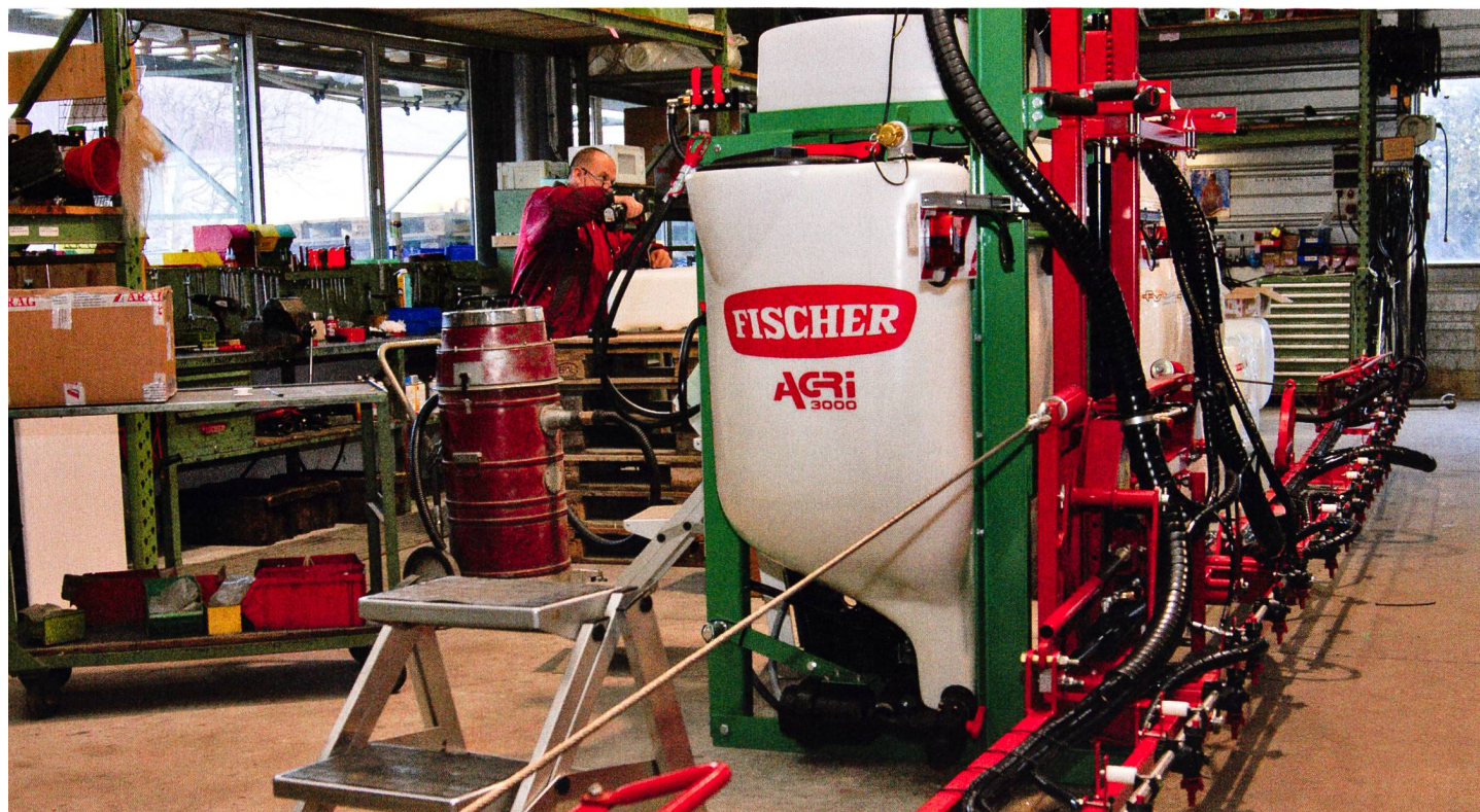
Aujourd'hui, la finition se concentre principalement sur le montage soigné des diverses composantes. Bien visible à l'image, le positionnement variable du corps des buses sur la tringle de la rampe de pulvérisation. (Photos : Ueli Zweifel)
