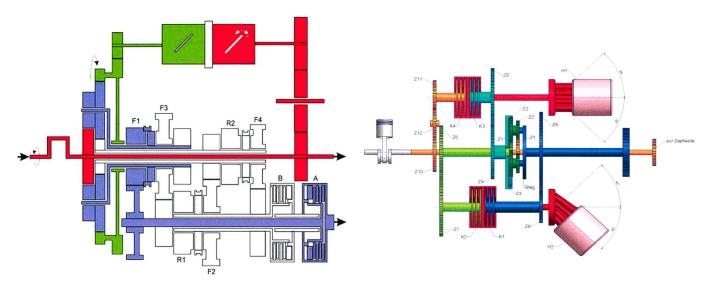
Case New Holland propose une toute nouvelle transmission continue pour ses tracteurs de 130 à 165 Ch. Elle fonctionne avec un embrayage double et dispose de deux gammes avant et une arrière, mais sa conception est plus simple que celle des transmissions qui équipent les plus gros tracteurs (170 à 250 Ch.).
