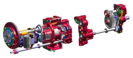
La nouvelle transmission TTV de Same Deutz-Fahr utilise un étage helicoïdal en entrée pour le partage de la puissance et un réducteur planétaire en sortie de transmission comme moyen de rassemblage (partie de gauche dans le milieu de l'image).
