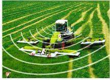
Dans le cadre du projet « Wildretter », Claas a développé un système de détection du gibier, utilisant une caméra de surveillance infrarouge. Celle-ci signale au chauffeur la présence d'animaux vivants. Outre les dégradations de matériels de fauche, le risque de botulisme provoqué par les restes de carcasses dans les fourrages est ainsi éliminé.
