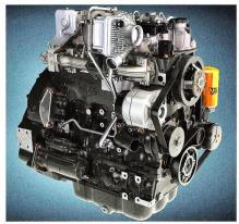
JCB SAS a mis au point le nouveau moteur « JCB Ecomax T4 » qui ne nécessite aucun traitement des gaz d'échappement. Cette performance est atteinte grâce à une forme de chambre de combustion aménagée dans la tête des pistons, à une rampe commune de seconde génération, à une géométrie de perçage des nez d'injecteur perfectionnée, à un turbocompresseur à géométrie variable et à un dispositif EGR – à boule de combustion – pour réduire la consommation de carburant.
