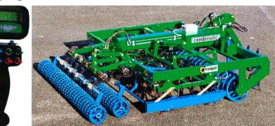
ces paramètres sont gérés par un boîtier électronique placé en cabine ; ce boîtier intègre un système de positionnement de l'outil parallèle au sol qui agit sur la longueur du vérin du troisième point. Sur la machine, le système adapte les réglages en fonction des conditions du sol, tout en assurant une profondeur de travail constante.
