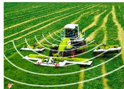
Dans le cadre du projet « Wildretter », Claas a développé un système de détection du gibier, utilisant une caméra de surveillance infrarouge. Celle-ci signale au chauffeur la présence d'animaux vivants. Outre les dégradations de matériels de fauche, le risque de botulisme provoqué par les restes de carcasses dans les fourrages est ainsi éliminé.
