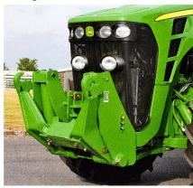
Le dispositif de commande du repliage d'un relevage avant améliore la sécurité et facilite l'utilisation d'un relevage. Le relevage passe de la position travail à la position stockage par simple action sur un interrupteur. Le retour en position de travail est automatique. Ce dispositif améliore la sécurité en supprimant les parties saillantes et le déport frontal.
