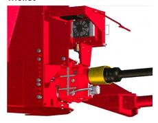
Trioliet a développé un nouveau boîtier réducteur « Powershift » à 2 vitesses sous charge, qui évite les problèmes liés au démarrage des mélangeuses de gros volume (18-30 m³). L'utilisateur peut changer les deux vitesses sans arrêter la prise de force du tracteur. Ce boîtier réducteur évite des charges énormes pour le système d'entraînement de la mélangeuse et du tracteur. Cinq programmes différents de pilotage du boitier peuvent être paramétrés en fonction du poids du chargement.
