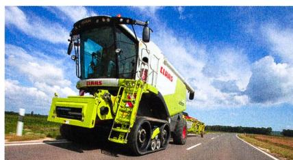
Une distinction aussi pour les chenilles à suspension développées pour les moissonneuses-batteuses Class. Le système de compensation active dans les virages autorise la vitesse de 40 km/h. Cet équipement préserve les sols en limitant
