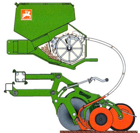
Détail du principe de fonctionnement du nouveau semoir EDX Amazone.
