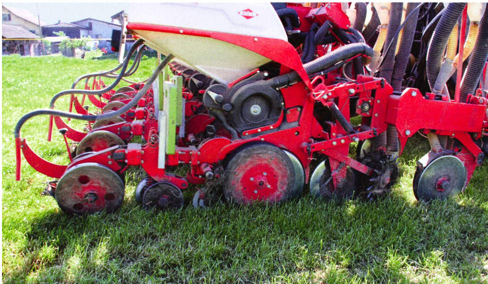
Fertilisation, chasse-débris, disques ouvreurs, mise en place de la graine, fermeture du sillon, application ciblée d'anti-limace et préservation des abeilles sont les tâches d'un semoir pour le semis direct.
