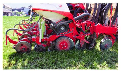
Fertilisation, chasse-débris, disques ouvreur, mise en place de la graine, fermeture du sillon, application ciblée d'anti-limace et préservation des abeilles sont les tâches d'un semoir pour le semis direct.
