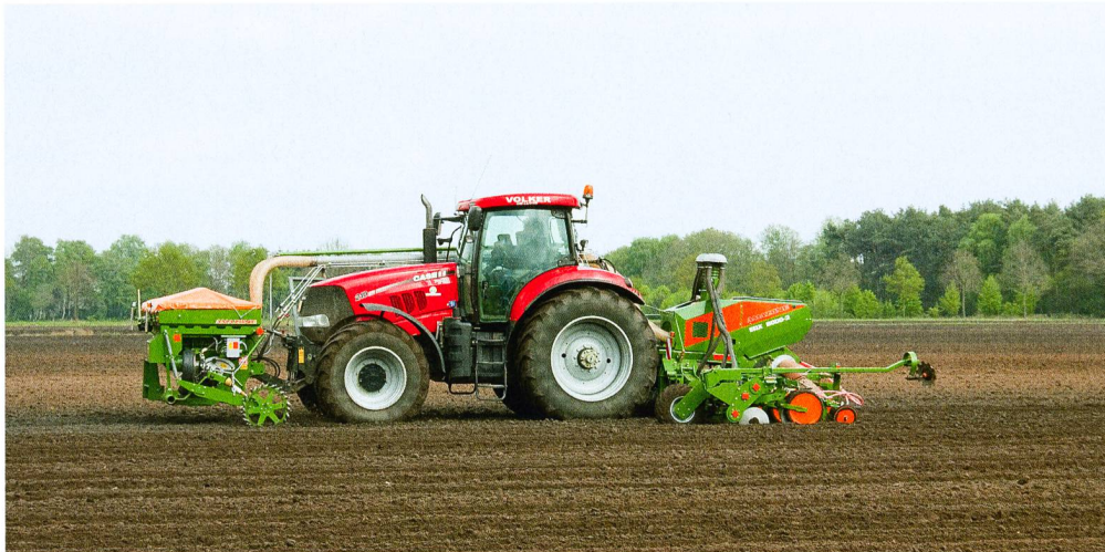
L'utilisation d'une trémie frontale augmente l'autonomie du semoir et apporte une meilleure répartition des charges sur le tracteur.
