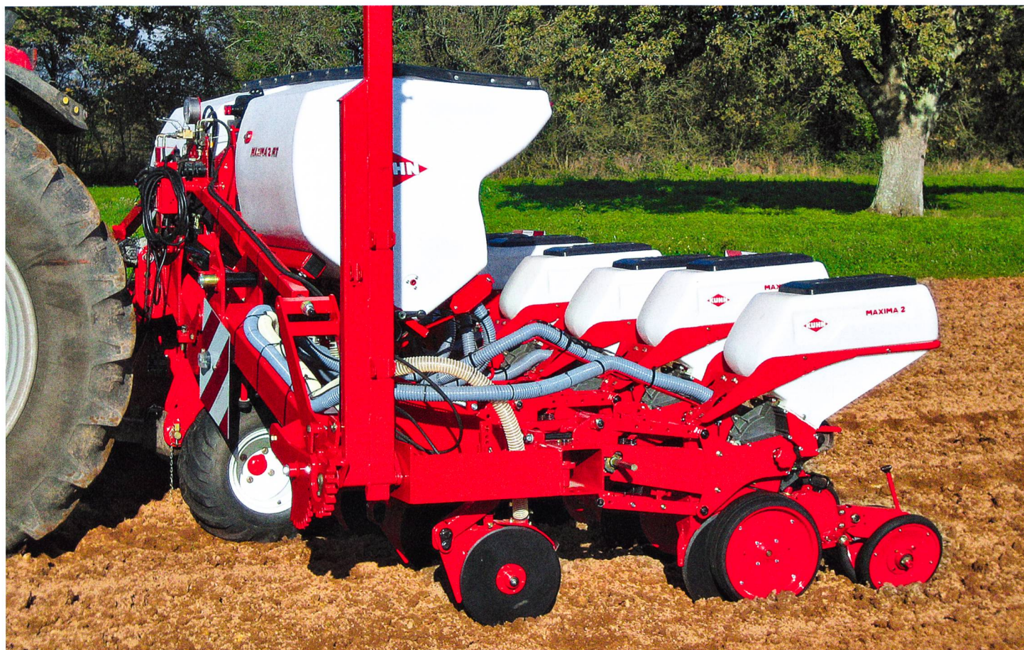
Augmentation des vitesses de travail, technologie GPS, semis direct, réduction des interlignes, autant d'éléments qui influencent directement la conception des semoirs de précision. (Photos d'usine).
