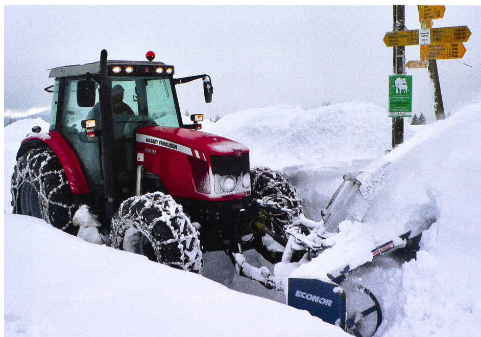
La fraiseuse déplace de gros tas. Mais le besoin en puissance et en carburant est beaucoup plus grand que pour travailler avec une lame. (Photo: Marianne Schupbach)
