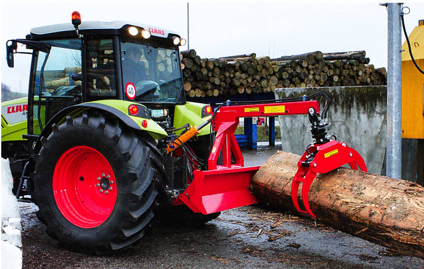
Les pinces de débardage peuvent être très efficaces pour le déplacement de petits et moyens bois (Photo : Ruckli AG, Buttisholz).
