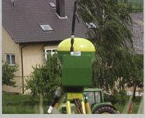
La station de base locale (RTK-DGPS Real Time Kinematic) peut être mobile et installée dans un champ, ou fixée sur un toit par exemple. La transmission des données se fait par radio ou réseau GSM (Global System for Mobile Communications).
