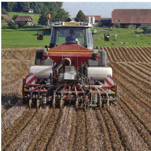
Deux rangs de colza sont semés par bande fraisée à une distance de 25 cm.
