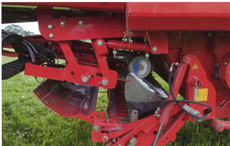
L'installation d'affûtage entièrement automatique aiguise les couteaux encastrés. (Source: Pöttinger)
