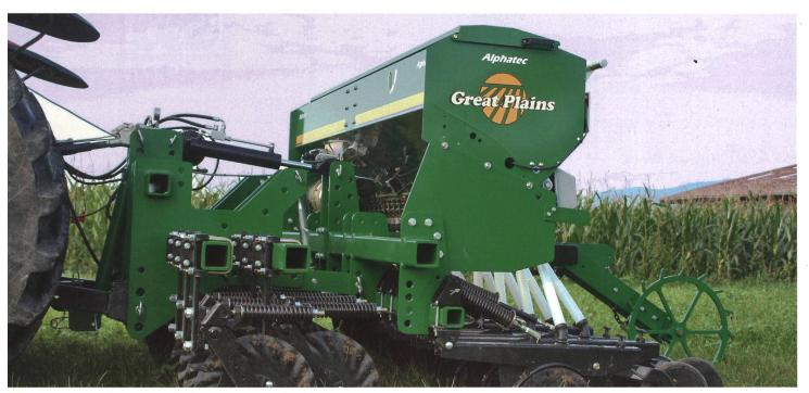
Alphatec : commerce et construction de machines agricole. Combinaison de semis direct montée sur un chassis très robuste de fabrication « maison ». (Photo d'usine)
