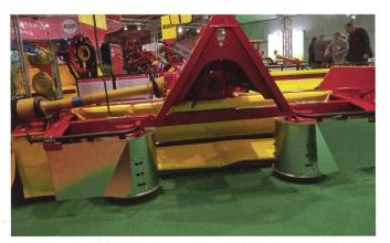
Felle a développé une faucheuse à disques frontale avec tambours convoyeurs pour le dépôt central de l'andain.
