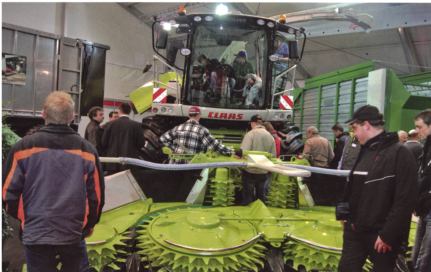
Une technique au top dans les installations provisoires de la foire : un prépressage actif par des rouleaux d'amenée, placés derrière la bec de récolte Orbis 450 de Claas. (Photos : Ueli Zweifel)
