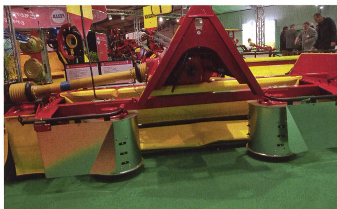
Felle a développé une faucheuse à disques frontale avec tambours convoyeurs pour le dépôt central de l'andain.
