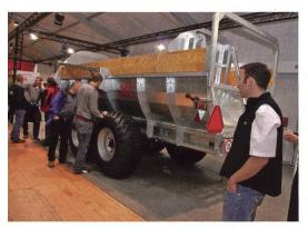
Une technique typique pour le marché suisse : un nouveau développement de l'épandeur à fumier avec distribution latérale de Gafner. Volume : 12m³, longueur du jet : jusqu'à 25 mètres.
