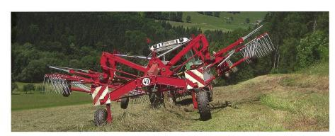
Grâce à un châssis large, la stabilité dans les pentes reste assurée même lorsque les toupies sont relevées.
