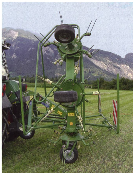
Le type d'utilisation, avec fourrage sec ou ensilage, détermine le diamètre des toupies.
