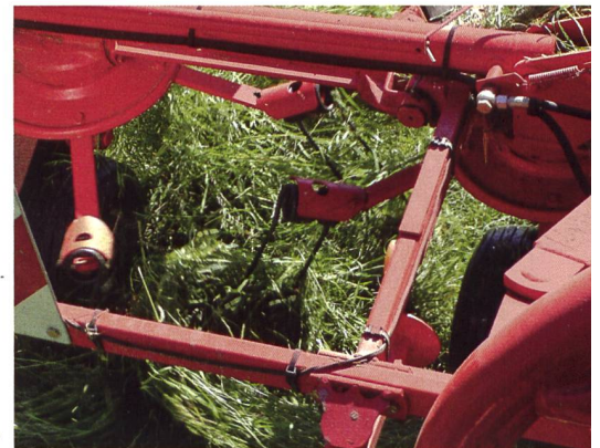
La qualité du travail lors du fanage dépend également de la hauteur de coupe, respectivement de la taille des tiges restantes.
