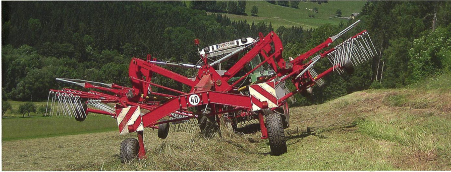
Grâce à un châssis large, la stabilité dans les pentes reste assurée même lorsque les toupies sont relevées.
