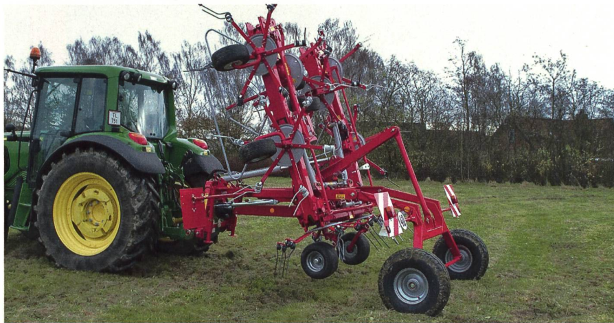
Les grosses pirouettes portées allègent massivement l'essieu avant du tracteur. Avec un essieu basculant, ce problème est en grande partie résolu.
