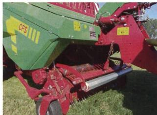
Les Giga-Vitesse CFS sont également dotés d'un fond en acier, de chaînes articulées pour le fond mouvant ainsi que d'un nouveau doseur démêleur monté en série avec trois rouleaux (Giga-Vitesse CFS), respectivement deux rouleaux sur la Super-Vitesse CFS. Avec ces nouveautés, les véhicules CFS s'adaptent aux exigences croissantes des autochargeuses à double usage.
