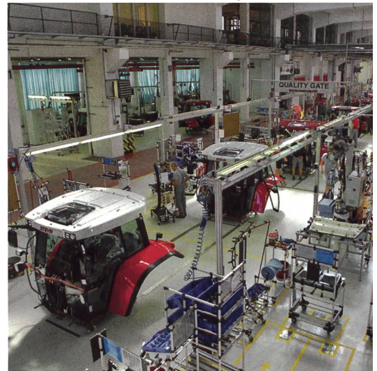
Dans la halle de montage des cabines, les cadres sont dotés de leur propre équipement. Les composants nécessaires sont préparés exprès pour chaque cabine. (Photo d'usine).
