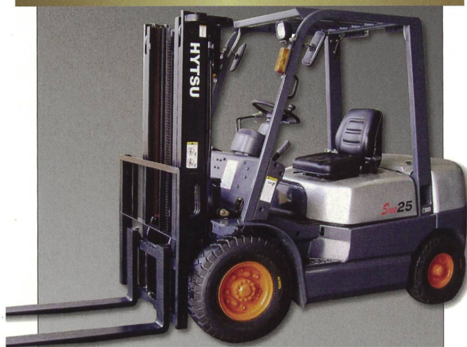
HYTSU FD 18 1,8 t | triplex 4,8 m | diesel
