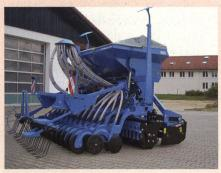
BMP Michel Baudet SA présente le nouveau semoir C-drill de ECK-landmaschinenbau. Ce semoir constitue une nouveauté dans ce domaine. Sa particularité réside dans les disques de semis CR à profondeur de semis réglable centralisé. Autres atout: l'accouplage rapide Easyfit, dosage de semis inférieur à 0.5 kg/ha, roue d'entraînement intérieure et construction compacte.
