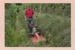
monoaxe de 89 kg pourra être équipé d'un broyeur éco-mulch dès le printemps 2011. Les deux couteaux, d'un diamètre de 70 cm, permettent maintenant de réaliser des travaux réservés jusqu'ici aux faux à moteur. En raison de sa légèreté et de sa maniabilité, la Rapid Rex est un outil idéal pour les travaux de fauche dans les vignes ou sur les bords de route.
