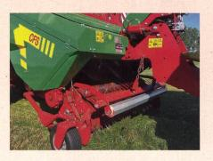
Agro-Technik Zulliger GmbH présente une nouvelle autochargeuse à rotor en spirale Strautmann. Cette nouvelle série d'autochargeuses de 32 à 80 m³ est équipée d'un rouleau accélérateur qui améliore le chargement et soulage la transmission. Le nouveau pick-up, dont les dents sont réparties en spirale, réduit de 10 % les besoins en puissance par rapport à une disposition traditionnelle en ligne.
