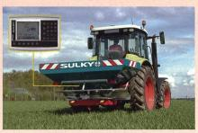
tiquement. Le DPX28, d'une capacité de 1500 litres, extensible à 2100 litres, dispose d'une largeur de travail réglable en continu de 12 à 28 mètres, ainsi que du Tribord pour l'épandage en bordure de parcelle. Le DPX28 dispose en série de ces équipements ainsi que d'une protection anticorrosion de la cuve, d'un attelage en chapes, d'un arceau de sécurité extérieur en inox, de l'éclairage intégré sur une barre inox et d'une transmission avec limiteur de couple.
