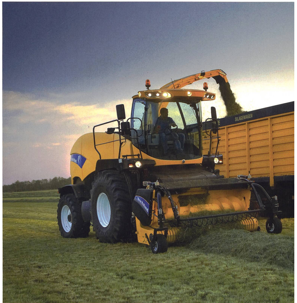
En plus des écrans Touch-Screen « Intelliview III » et du système de commande de la goulotte « IntelliFill », les ensileuses FR peuvent être équipées de systèmes de mesure de l'humidité et de mesure du rendement
