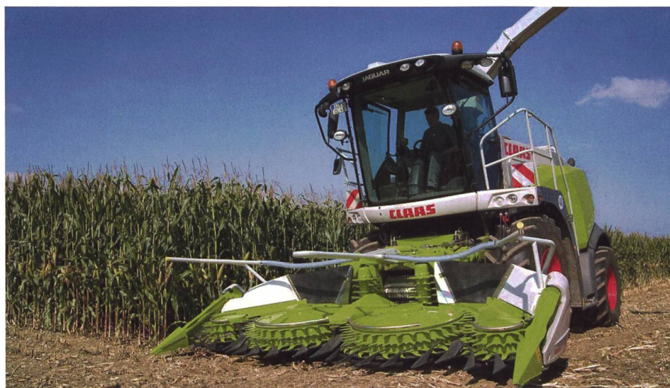
Nouveau cueilleur 6 rangs Orbis 450 de Claas prévu pour la saison 2011. Les deux grands tambours centraux tournent vers l'extérieur.
