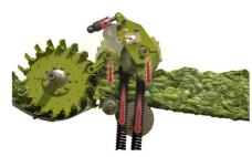
Pré-compression active : un vérin hydraulique évite les sauts des rouleaux.
