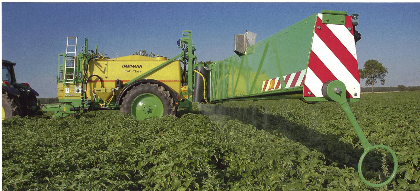
Tendance de la protection phytosanitaire : les constructeurs basent leur promotion, entre autres, sur la stabilité des rampes d'épandage et des buses, ce qui permet une vitesse de travail élevée
