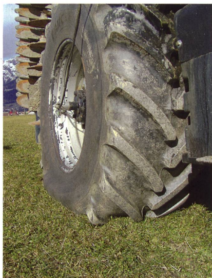
Tendance de la technique des pneus : de nouvelles technologies permettent de rouler à la fois sur route et dans les champs avec des pneus à basse pression.
