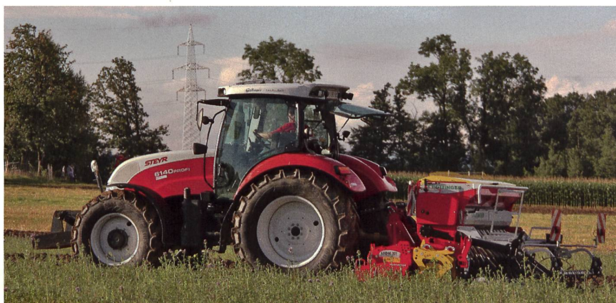
La combinaison de semis Lion 301 et Vitasem a fait l'objet de nombreuses améliorations, notamment au niveau du système de dosage de la semence.
