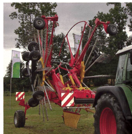
Le nouvel andaineur TOP 852 C se caractérise par un nouveau châssis à 6 roues et la nouvelle cinématique de relèvement des rotors.
