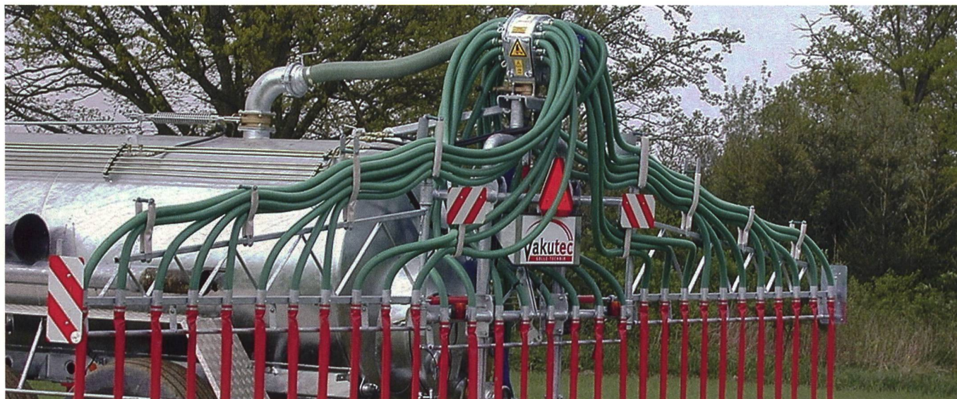
L'équipement d'une citerne à pression avec un répartiteur à pendillards double environ le prix d'achat. Le potentiel d'économie par un degré d'utilisation élevé augmente donc en conséquence.
