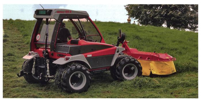
Reforme présentait ses nouvelles faucheuses à deux essieux des séries G5X, à transmission mécanique, et H5X, à transmission hydrostatique. (Photos: Ueli Zweifel)
