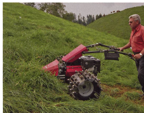
Le monoaxe hydrostatique Koppel avec ses HillSpikes amovibles.
