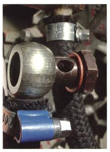
Le trou ovale de la vis percée de cette conduite de carburant témoigne d'une déformation suite à un serrage excessif.
