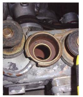
Ces types de bouchons de radiateur, pliés et fendus (à gauche) et oxydés et cassés (à droite), sont fréquents sur les anciens véhicules.
