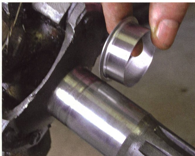
La bague de protection adéquate est mise en place au moyen d'un tube adapté.
