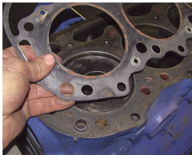
Le montage d'un joint de culasse nécessite de connaître l'ordre de montage ainsi que le serrage de chaque vis.
