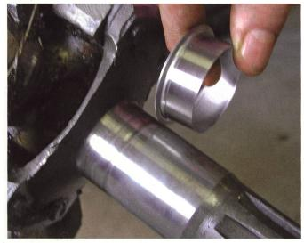
La bague de protection adéquate est mise en place au moyen d'un tube adapté.
