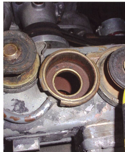
Ces types de bouchons de radiateur, pliés et fendus (à gauche) et oxydés et cassés (à droite), sont fréquents sur les anciens véhicules.
