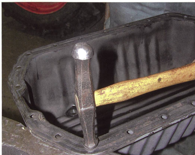
Les trous de fixation de ce carter en tôle ont été redressés.
