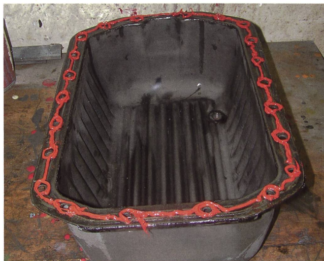
Une pâte d'étanchéité doit être appliquée sur la pièce. Un séchage d'une dizaine de minutes avant le montage en améliore l'efficacité.
