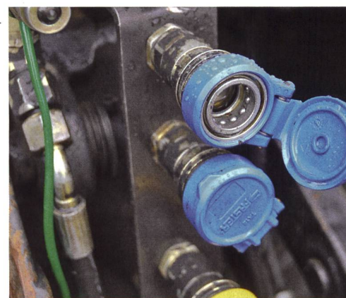
Pratique : les accouplements rapides pour les outils portés à entraînement hydraulique – ces éléments doivent être systématiquement à l'abri de l'eau et de la saleté.
