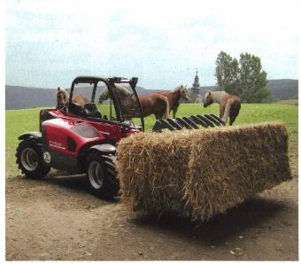
Afin d'utiliser les chargeurs télescopiques dans les endroits exigus, des modèles compacts sont maintenant proposés par les constructeurs. Ils pourraient remplacer les chargeurs de ferme dans certains cas. « Une hauteur de levage élevée avec des dimensions extérieures compactes », telle est la devise.
