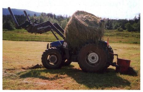
Les tracteurs sans cabine ne doivent pas être équipés d'un chargeur frontal. Le danger est le même qu'avec un chargeur de ferme dépourvu de toit de protection.
