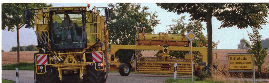
Comme les moissonneuses-batteuses, les organes d'arrachage trop larges pour le trafic routiers sont traînés sur des chariots.
