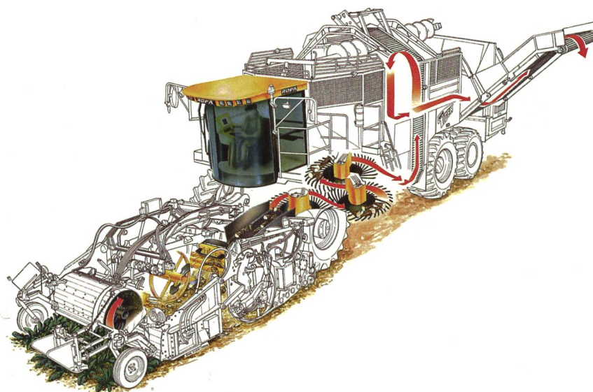
La conception des organes d'arrachage et de nettoyage influence directement les dimensions des récolteuses totales automotrices.
