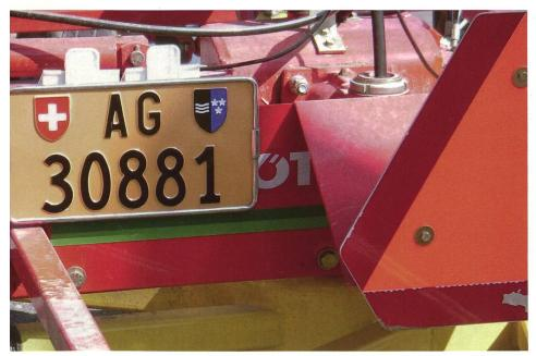
Dès qu'un véhicule ne respecte pas, de par ses dimensions, les conditions décrites par l'OETV\*, il portera une plaque de contrôle brune. Ces véhicules spéciaux sont soumis à des conditions plus strictes.
