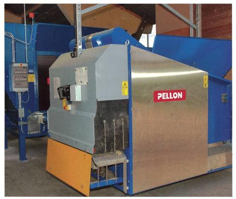
Le remplissage des différents conteneurs d'attente (à l'arrière-plan) se fait au travers des parois ouvertes de l'étable. Le robot de mélange et de distribution est en position de parc.
