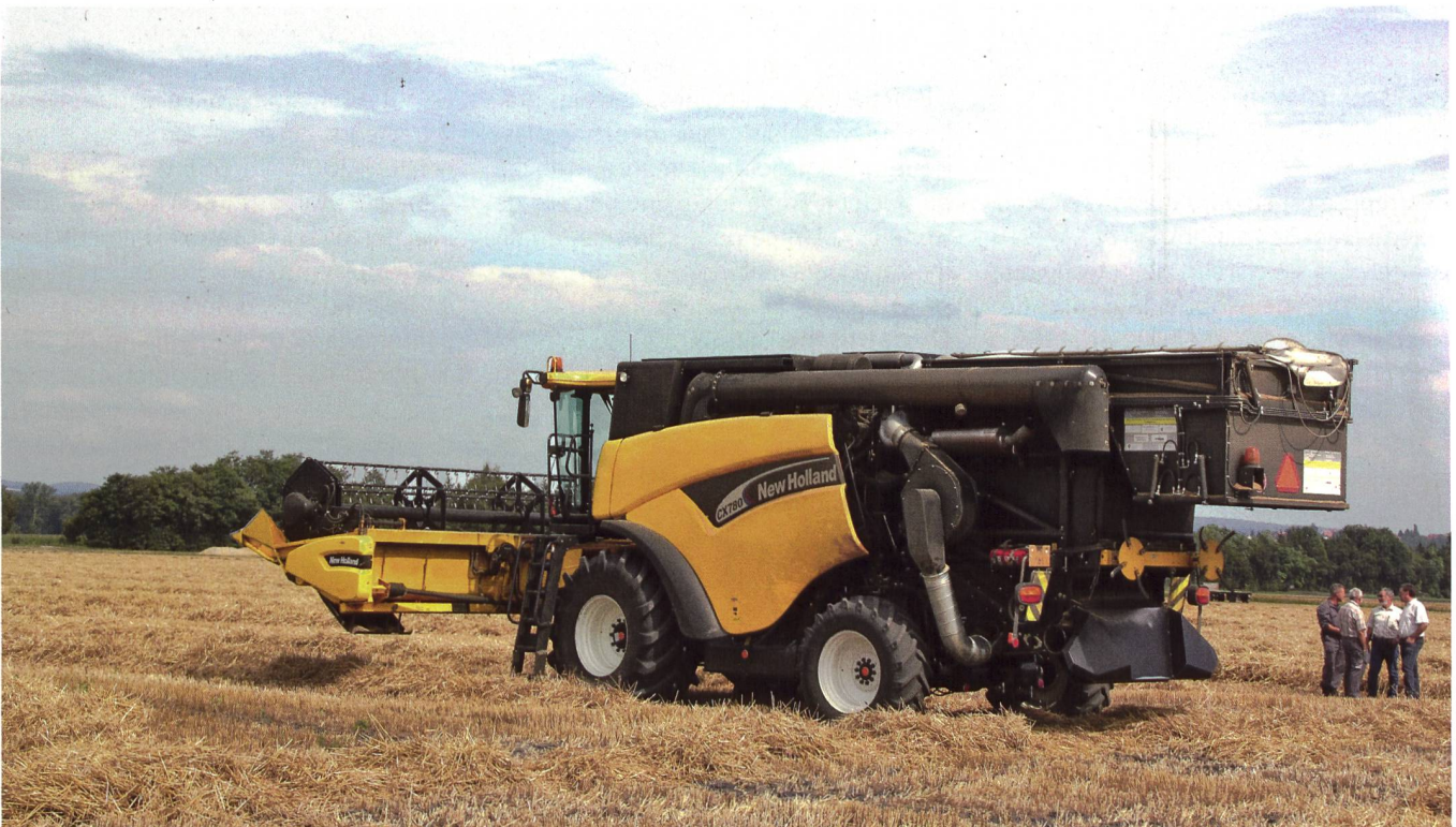
En position de transport, le système de récupération des paillettes respecte les gabarits routiers.
