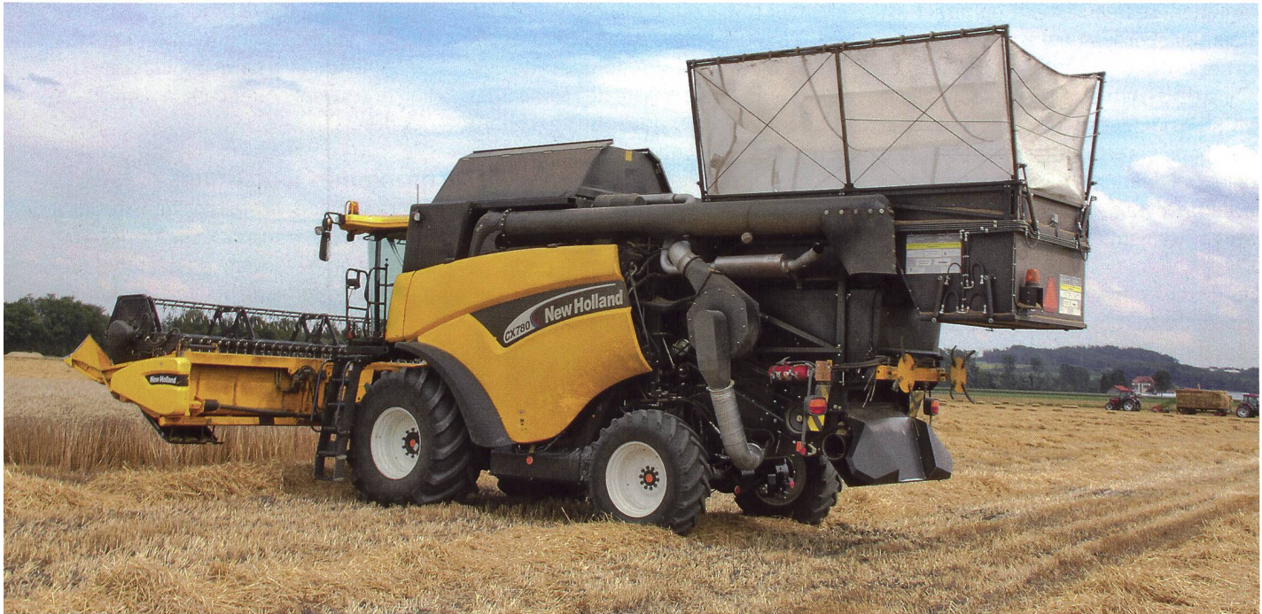
La moissonneuse-batteuse des Etablissements de Bellechasse a été modifiée pour récolter les glumes et menues pailles dans le cadre d'un projet placé sous la direction de la Haute école suisse d'agronomie de Zollikofen.
