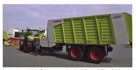
Les remorques combinées Cargos avec un tapis roulant à élévation de 50 cm. Pour les chantiers d'ensilage avec ensileuse automotrice, les éléments de chargement et de déchargement peuvent être démontés en 15 minutes. Un nouveau système de pesée est aussi disponible.
