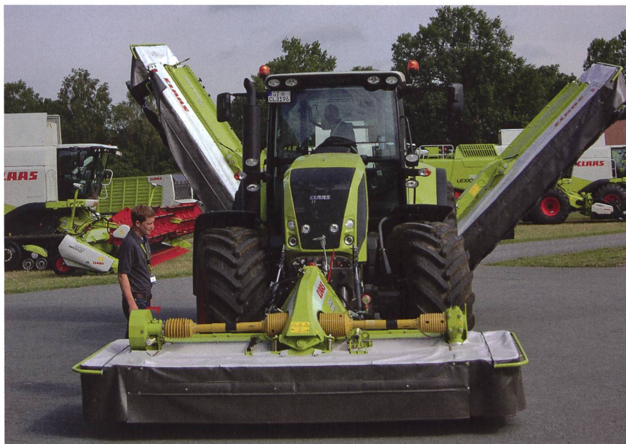
Les nouvelles faucheuses avec conditionneur à rouleaux et suspension hydropneumatique Active Float.
