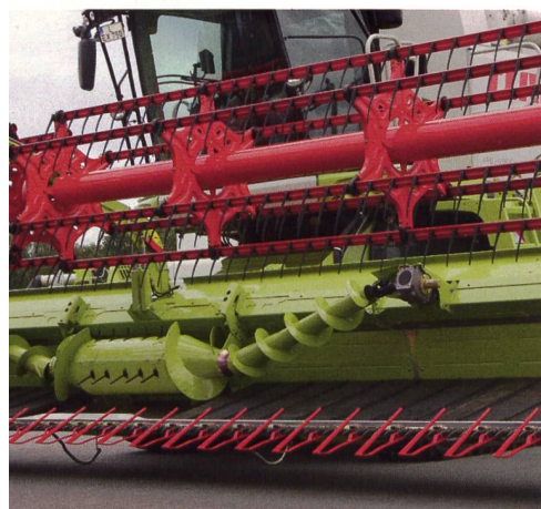
La barre de coupe Maxflo : des tapis transportent la récolte vers le canal de transfert.
