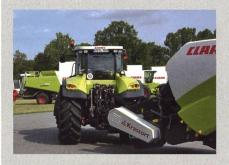
380 RC avec ou sans RotoCut disposent maintenant d'une trappe qui s'ouvre pour éviter les bourrages. Les couteaux et caissons retournent immédiatement en position initiale. Le broyeur à paille intégré Krassort, disponible dès 2011, travaille plus de 10 cm au-dessus du sol et aspire la paille. Cette particularité réduit le risque d'incendie. (Pour le moment, le broyeur à paille n'est disponible que pour le marché allemand.)
