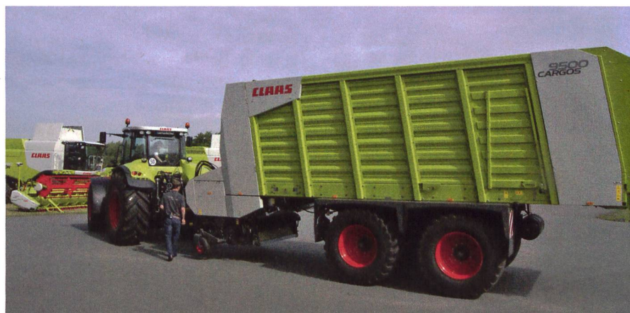
Les remorques combinées Cargos avec un tapis roulant à élévation de 50 cm. Pour les chantiers d'ensilage avec ensileuse automotrice, les éléments de chargement et de déchargement peuvent être démontés en 15 minutes. Un nouveau système de pesée est aussi disponible.
