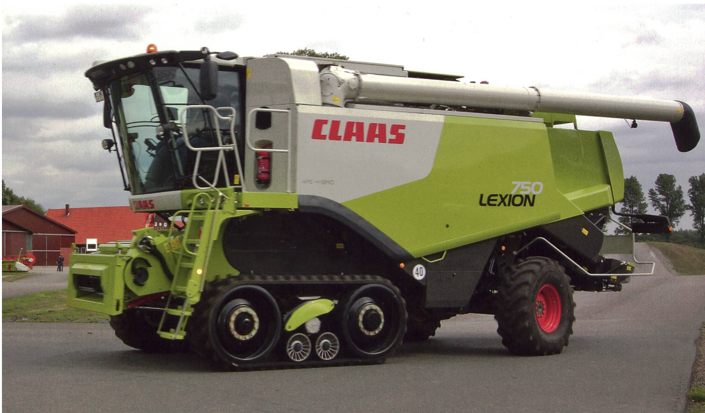
La nouvelle série Lexion 750 Hybride, présentée avec le train de chenilles Terra Trac visiblement amélioré. (Photos : Ueli Zweifel)
