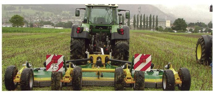
Les machines à axe horizontal sont sur le marché pour le traitement des grandes surfaces.
