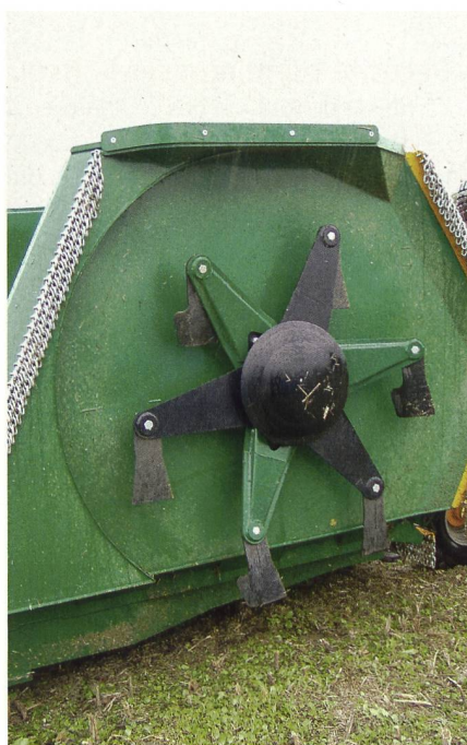
Les couteaux de cette broyeur travaillent horizontalement coupent à deux hauteurs différentes, ce qui améliore l'effet de broyage.
