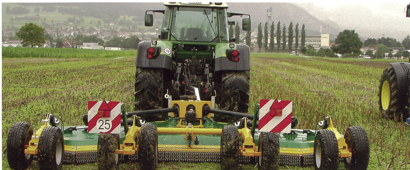
Les machines à axe horizontal sont sur le marché pour le traitement des grandes surfaces.
