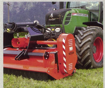
Les pièces métalliques ou les pierres projetées sont captées par un rideau de protection composé de plaques métalliques pendantes (en noir sur la photo).
