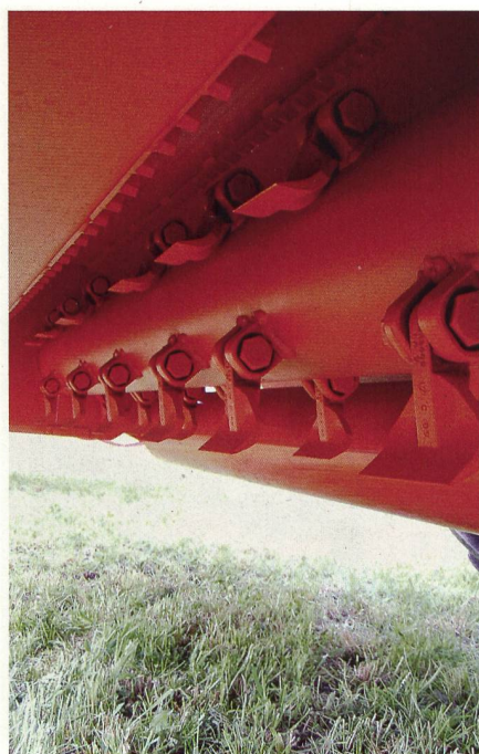
Les fléaux broient les résidus de récolte. De plus, le peigne monté sur l'angle du couvercle assure un broyage complémentaire.
