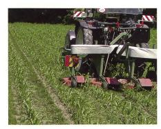
Une broyeuse interligne permet aussi le semis en ligne de maïs dans une exploitation bio.
