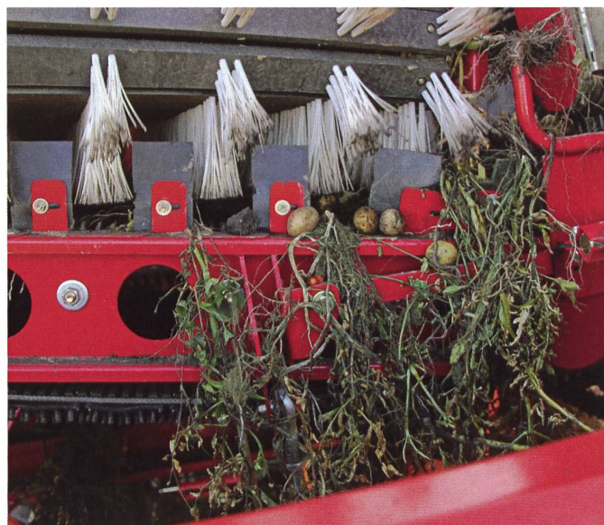
Les machines modernes disposent de systèmes permettant de séparer efficacement les tubercules des fanes.
