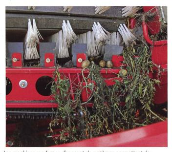
Les machines modernes disposent de systèmes permettant de séparer efficacement les tubercules des fanes.
