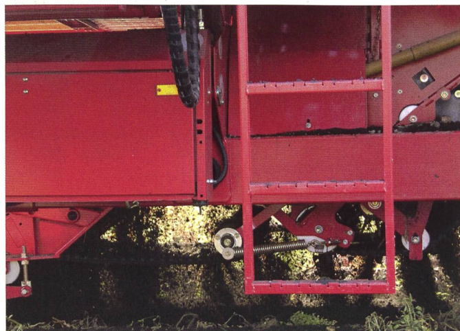
Les tapis de transfert doivent être réglés pour qu'une légère couche de terre subsiste encore en fin de tapis.
