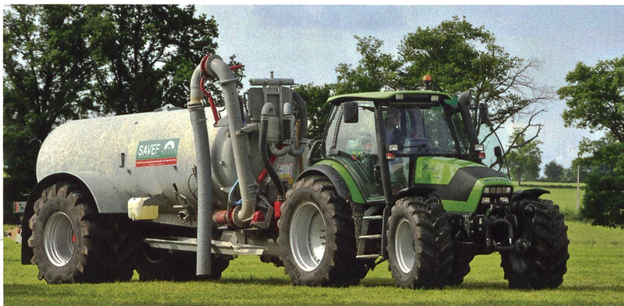
En réduisant le diamètre des jantes et en augmentant la largeur des pneus, il est possible d'accroître la capacité de charge sans augmenter la pression au sol.
