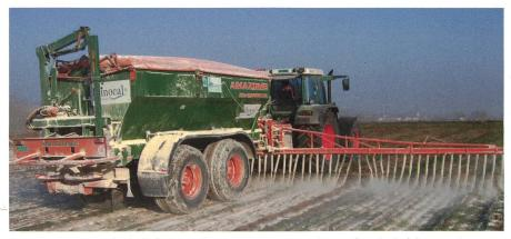
Répartition optimale de la fine poudre de calcaire avec un épandeur à vis (Photo: Briner AG Hagenbuch).
