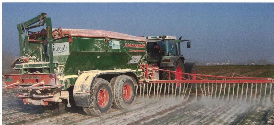
Répartition optimale de la fine poudre de calcaire avec un épandeur à vis (Photo: Briner AG Hagenbuch).
