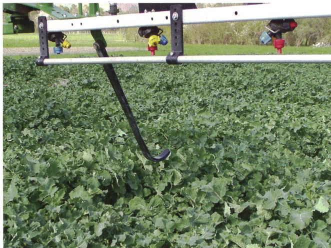
La distance entre la rampe et la surface-cible doit toujours être identique, que l'on vise le sol ou une culture.
