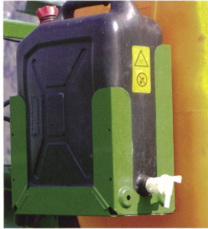
Un réservoir d'eau pour le lavage des mains fait partie de l'équipement d'un pulvérisateur moderne.
