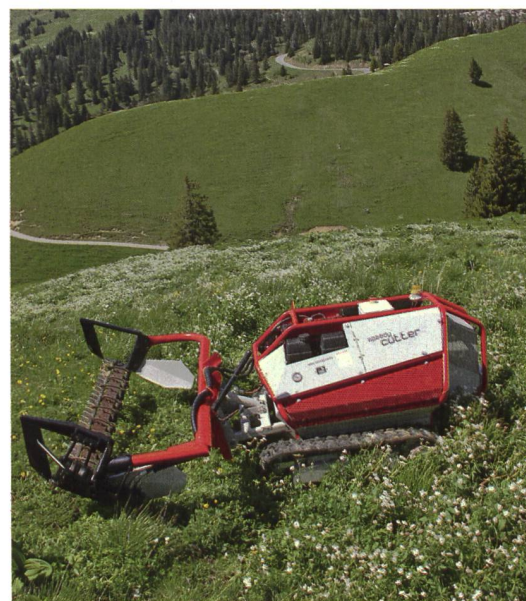
Les porte-outils télécommandés permettent à l'utilisateur de rester hors de la zone dangereuse.
