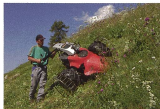
Combicut Aebi CC66: la motofaucheuse monoaxe hydrostatique confort avec la direction active.
