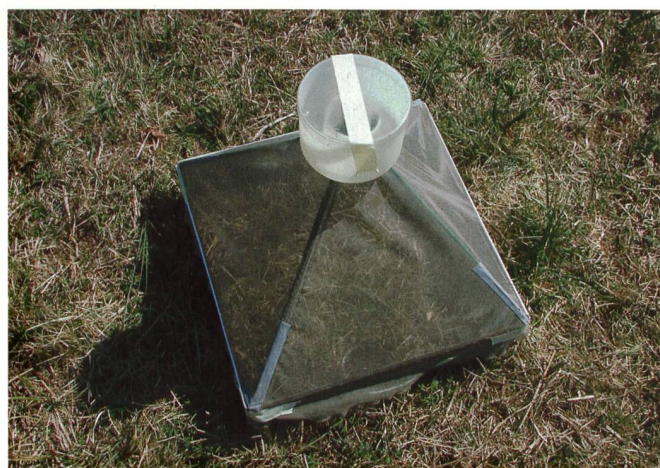
Fig. 8. Pièges à émergence 50 x 50 cm; les insectes et araignées sont piégés dans la boîte du dessus (Photo: Sabine Rocker, ETH).
